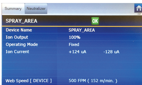
La pantalla de resumen proporciona la información más importante del dispositivo, como el nombre, salida/corriente de iones, y modo de funcionamiento.
